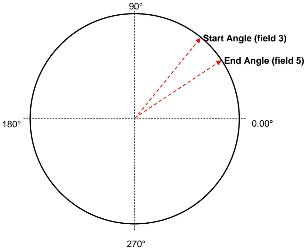
**FIGURE 6: LOCATION OF A SIDE DRILLING FEATURE (START ANGLE, END ANGLE) VIEWED FROM THE LENS FRONT**
